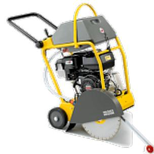
Бензиновый шовнарезчик BFS 1345 - флагманская модель резчика швов Wacker Neuson с глубиной пропила 19,5 см. Есть возможность работать сдвоенными кругами, для увеличения ширины пропила. Система орошения с баком воды на 32 литра, равномерно подает жидкость на режущую часть, при этом блокируется образование пылевой завесы. Силовой привод Honda GX 390 прекрасно держит обороты при малых и больших нагрузках.
